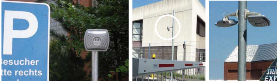
Unterschiedliche Montagemöglichkeiten der UHF Leserantenne
